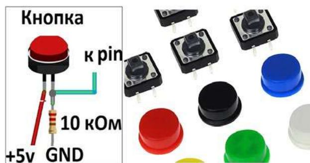
Рис. 1. Схема подключения тактовой кнопки к микроконтроллерной плате
